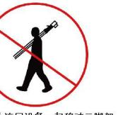
严格禁止连同设备一起移动三脚架
